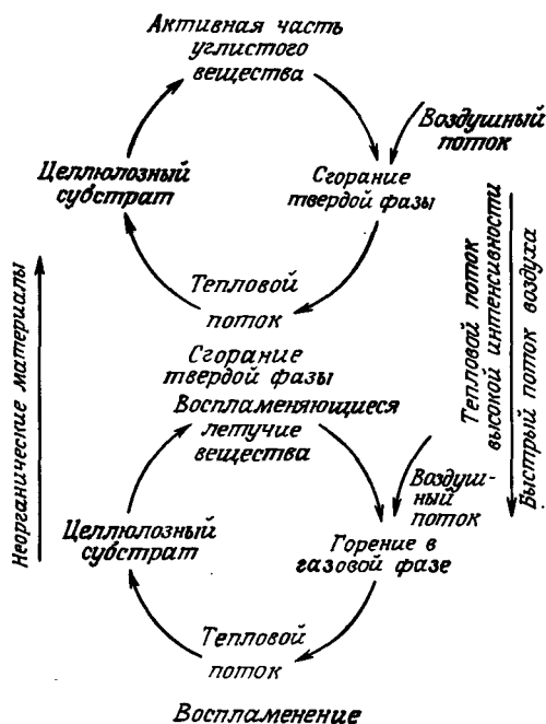
Рис. 10. Схема пламенного и медленного сгорания летучих горючих компонент и углистого вещества, образующихся в процессе пиролиза биомассы.
